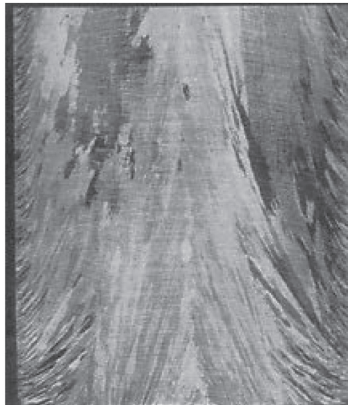
▲ شکل ۱۴- الف-ساختار شمش پس از انجماد ب-ساختار شمش پس از ESR [۷].
