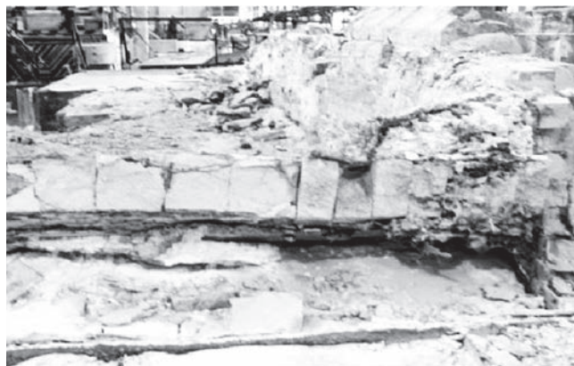
▲ شکل ۴- خرابی کوره نگهدارنده آجری. آلومینیوم نفوذ کرده از درز بین آجرها به وضوح دیده می شود.
