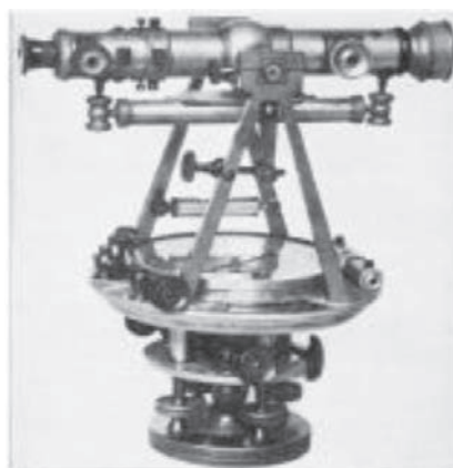
▲ شکل ۲- دوربینی که با قطعات آلومینیومی ریخته شده در کارگاه فریش موث ساخته شد.
