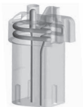
▲ شکل ۱۰- کانال خنک کاری که به روش پرینت سه بعدی ساخته شده است
