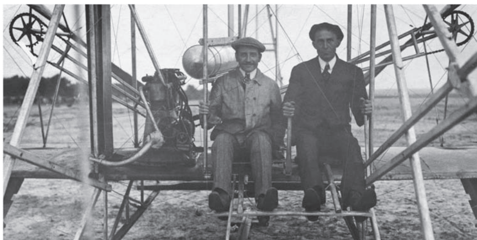
▲ شکل ۶- برادران رایت و نخستین هواپیما با موتوری مجهز به بلوک و کپه یاتاقان آلومینیومی.
