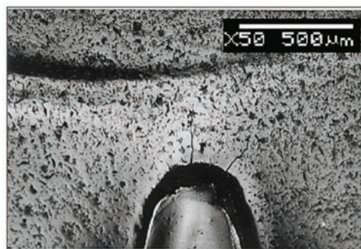
شکل ۵- سطح کار قالب مورد آزمایش. حفره ها و ترکها. میکروسکوپ نوری
