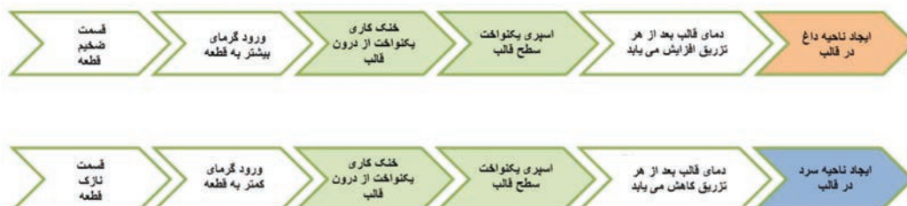
شکل ۴- دیاگرامی از جریان گرما در نواحی مختلف قالب.
