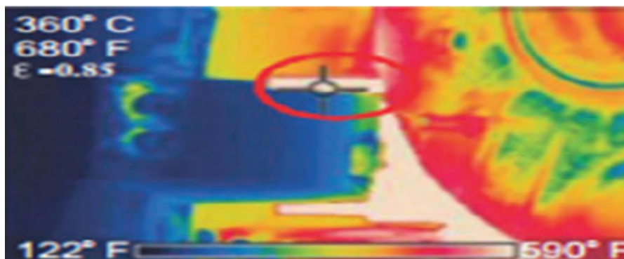
شکل ۲- تصویر گرمایی از قالبی که تعادل گرمایی ندارد.
