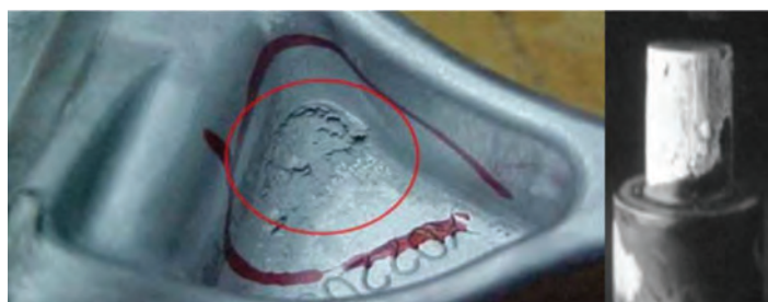
شکل ۴- قطعه دایکست شده با عیب لحیم شدگی (سمت چپ) و پین ماهیچه با لحیم شدگی (سمت راست).
