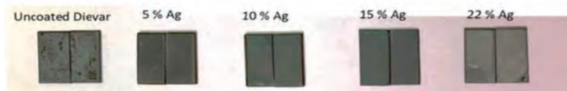
شکل ۷ - تصویر نمونه های پوشش CrAlAgN پس از آزمون چرخه حرارتی به مدت ۱۲۰۰ چرخه.
