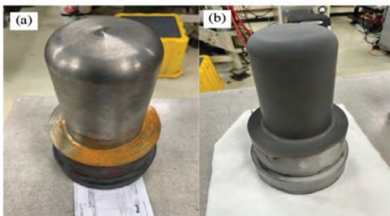
شکل ۱۱- تصاویر پانچ آزمایشی در محیط صنعتی: (a) قبل از اعمال پوشش نانوکامپوزیتی خودروانکار و (b) پس از اعمال پوشش نانوکامپوزیتی خودروانکار.
