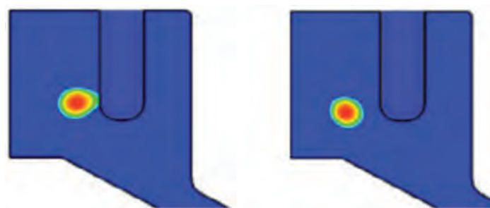
شکل ۷- انجماد شبیه سازی شده شامل موقعیت ناحیه داغ یا تخلخل (سمت چپ) و بعد از بهینه سازی خنک کاری که حفره تغییر مکان داده است (سمت راست).
