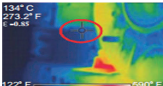
شکل ۶- تصویر گرمایی قالب پس از ایجاد تعادل گرمایی.
