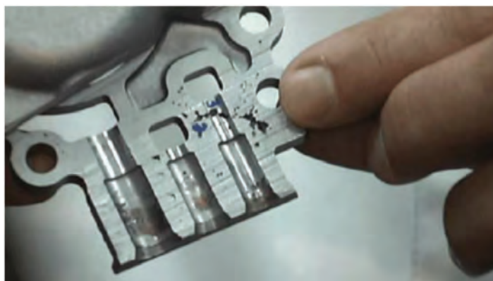
شکل ۳- مقطع قطعه برای نمایش دادن عیب تخلخل انقباضی.
