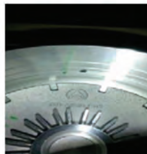
شکل ۳- قطعات مردود به دلیل حضور فیلم اکسید دولایه که منجر به تخریب و تعویض ابزار نیز شده اند.
