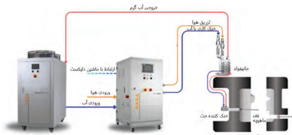
شکل ۹- ماشین خنک کننده جت مدار بسته و نحوه اتصال آن به قالب و ماشین دایکست.
